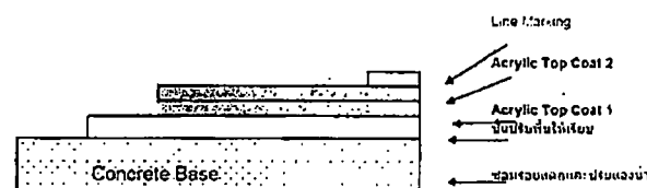
รูปตัดแสดงชั้นงาน scale NTS
