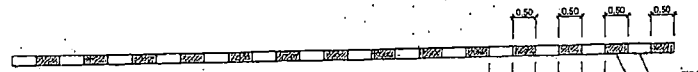
RM 5/1 เส้นห้ามหยุดหรือจอดรถ NO PARKING (RED AND WHITE)
